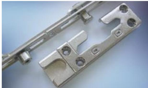
Auf Wunsch können unterschiedliche Stufen des einbruchhemmenden Sicherheitsbeschlages eingesetzt werden. Dabei verkrallen sich hochfeste Pilzzapfen in Schließelemente aus gehärtetem Stahl. Jede Schließstelle kann so Kräfte von bis zu 1.5 Tonnen aufnehmen.
